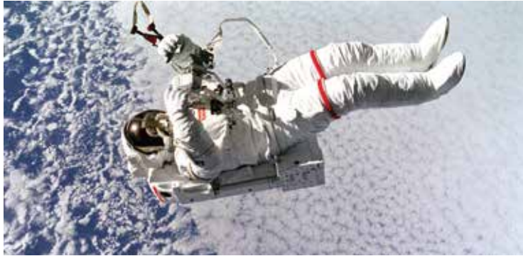
Astronauta movilizándose en el espacio gracias a la "Ayuda Simplificada para Rescate EVA" (EVA significa "actividad extravehicular"). Se trata de un pequeño sistema de mochila de propulsión autónomo usado para proporcionar movilidad de vuelo libre a un tripulante.
