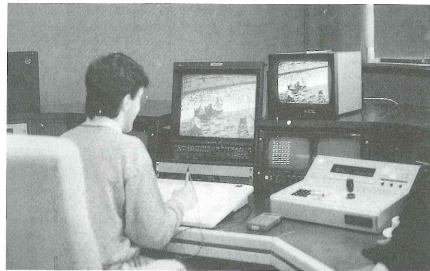
Fig. 145.— La paleta electrónica permite modificar a capricho cualquier imagen grabada.
